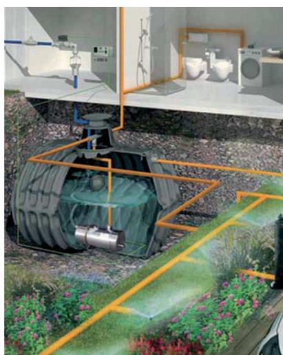
Remplissage, vidange et surpression (électropompe submersible)
