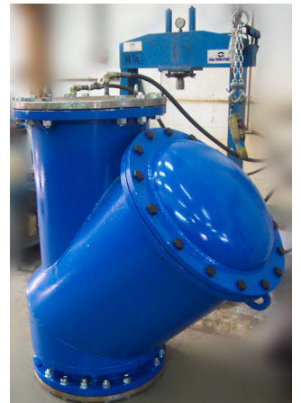
TEST HYDRAULIQUE DN500
