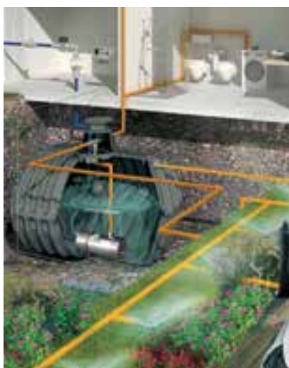
Remplissage, vidange et surpression (électropompe submersible)
