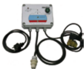
Kit de gestion pour citerne En cas de pluviométrie insuffisante, ce kit assure l'appoint en eau grâce à son électrovanne raccordée au réseau. • Bloc 4 sondes inox avec câble 20 m • Electrovanne NF 1/2" avec câble 2 m • Câble d'alimentation 2 m • 4 voyants de signalisation
